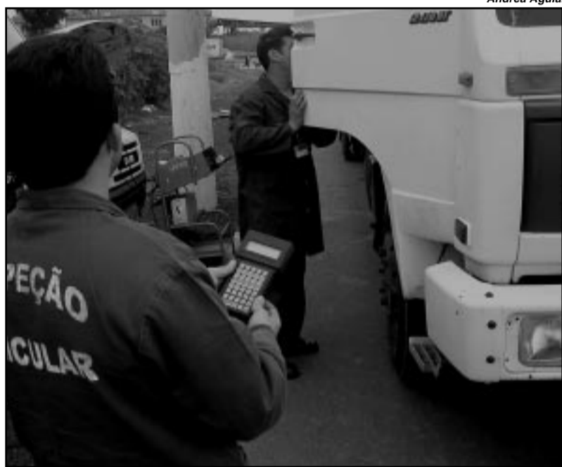
Equipamento chamado opacímetro permite medição do índice de poluição
